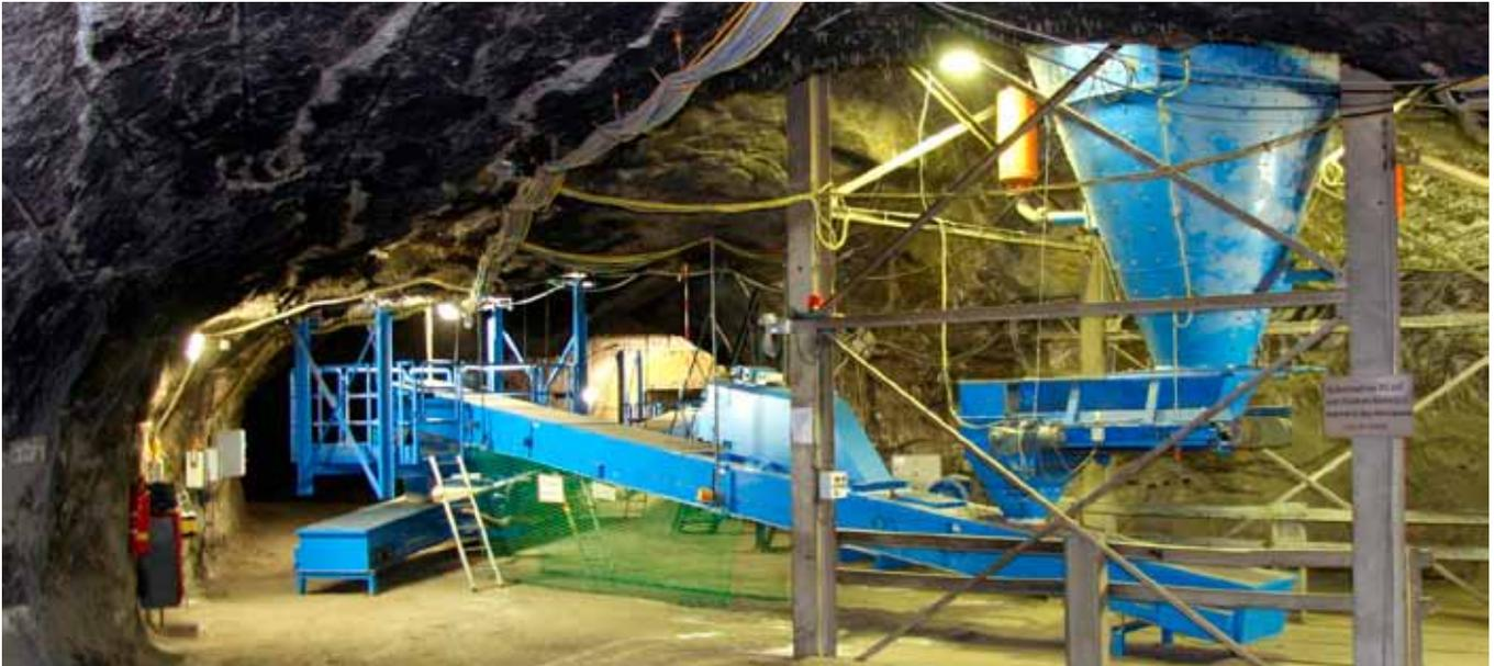
▲ Transport von Versatzmaterial mit gekapselten Förderbändern von der Schachtfalleitung zur Lkw-Verladung
