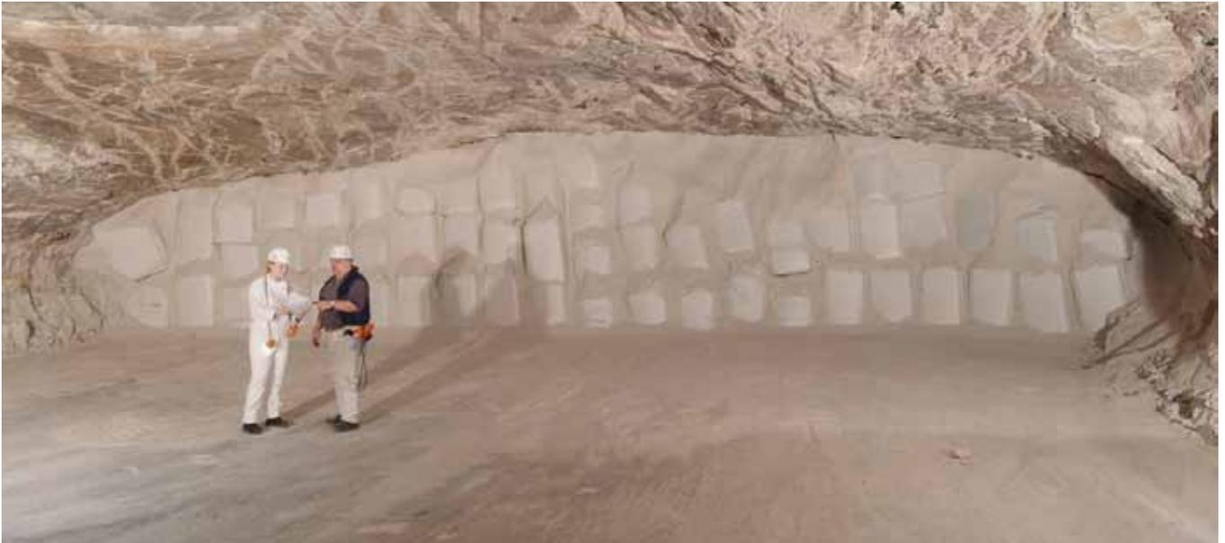
▲ **Versatzfront: Die Big-Bags sind zur Verfüllung von Zwischenräumen und zur Anbindung an das Gebirge mit angefeuchtetem Feinsalz verschleudert**
