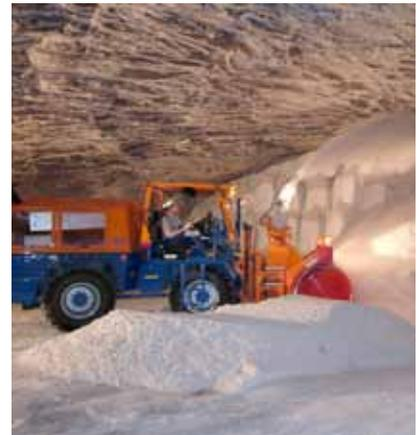
▲ **Verschleudern von angefeuchtem Feinsalz zur Verfüllung von Resthohlräumen zwischen den Big-Bags mittels einer modifizierten Schneefräse**
